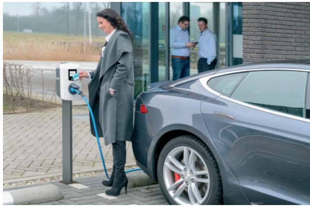
Abb. 59: Wallbox mit integriertem Display – Alfen EVE Single Pro-Line (Quelle: Alfen).
