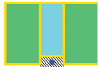
Abb. 27: Mögliche Integration eines Parkplatzes für Motorräder/ vierrädrige Leichtfahrzeuge (in blauer Farbe hervorgehoben) mit 2 Parkplätzen. Ein praktisches Anwendungsbeispiel für solche Auslegung wird in Abb. 30 gezeigt.
