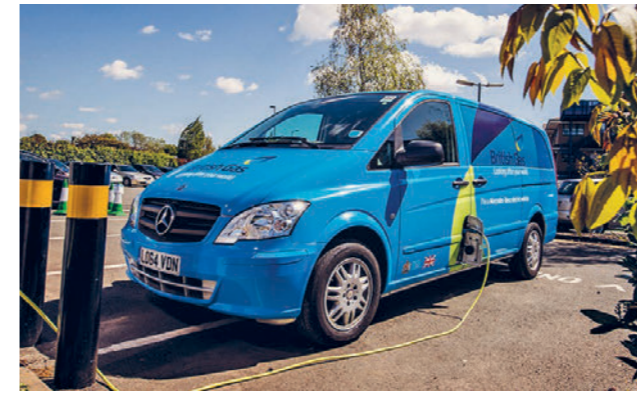
Abb. 11: Beim neuesten Mercedes-Benz Van (2018) ist die Anschluss-Position am Ende der Fahrertür, ungefähr gegen Automitte, Pos. 7 bei einem normalen Fahrzeug.
