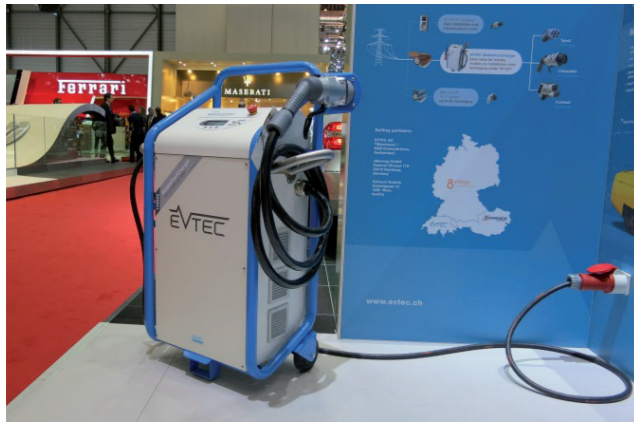
Abb. 49: Beispiel einer mobilen Ladestation mit CEE-Stecker (Quelle: EVTEC).
